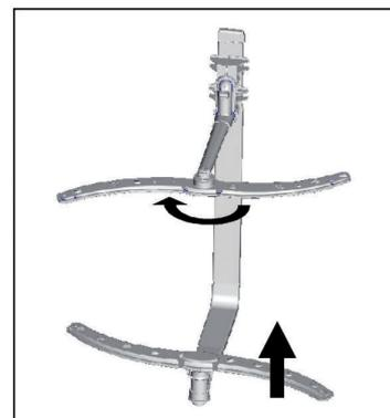
Pour retirer le bras d'aspersion supérieur : Maintenez le bras supérieur et tournez l'écrou cranté dans le sens des aiguilles d'une montre. Puis, dégagez le bras en le tirant vers le bas.
