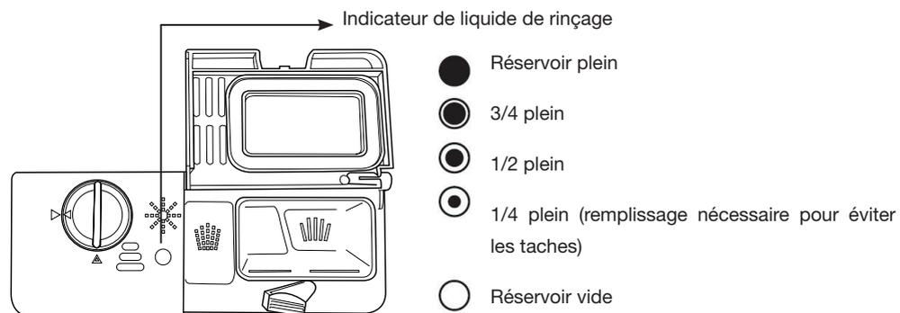
Le point noir sur le distributeur de produit de rinçage indique la quantité de produit de rinçage disponible dans le distributeur. Plus la quantité de produit de rinçage diminue, plus la taille du point noir se réduit. Le niveau de liquide de rinçage ne doit jamais se situer au-dessous d' 1/4.
