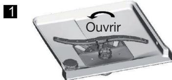
Étape 1 : Tournez le filtre à déchets dans le sens inverse des aiguilles d'une montre.
